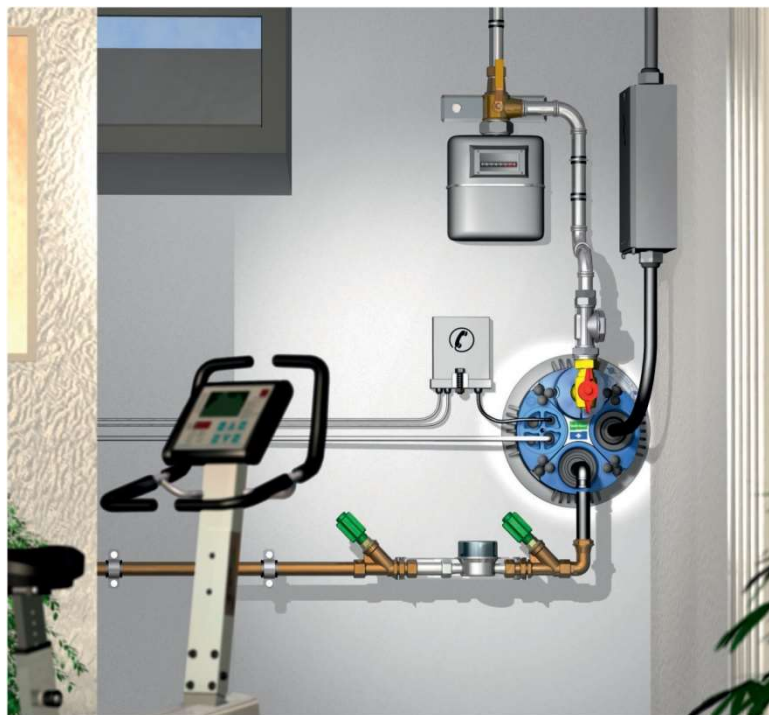
© Fachverband Hauseinführungen für Rohre und Kabel e.V. Mehrsparten-Hauseinführung für unterkellerte Gebäude (Innenansicht)
